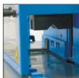
Сменные направляющие (двух размеров) для оптимального позиционирования рукавов разных размеров (только для EM 115)
