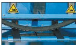
Возможность выбора разных точек изгиба для обеспечения прямого среза и предотвращения пережима лезвия.
