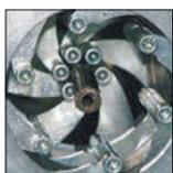
Улучшенная фиксация при помощи зажима для центрирования рукавов. Увеличенная длина рифленых роликов для обеспечения лучшего захвата.
