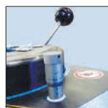
Микрометр позволяет легко задавать диаметр обжима.
