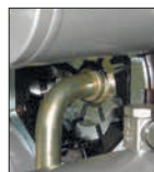
Прессы серии S 4 можно использовать для обжима коротких отводов 90° с длинными наконечниками. При использовании стандартных обжимных машин это было бы невозможно.
