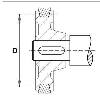
**F<sub>r2</sub> - Carico radiale - Radial (overhung) load - Radialkräfte**
