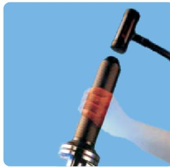
В случае с разборными подшипниками внутреннее кольцо может устанавливаться независимо от наружного кольца, что упрощает процедуру монтажа, особенно когда оба кольца имеют посадку с натягом. При установке вала с уже установленным на нем внутренним кольцом в корпус с наружным кольцом необходимо внимательно следить за отсутствием перекоса колец, возникновение которого может вызвать задиры на дорожках и телах качения.
