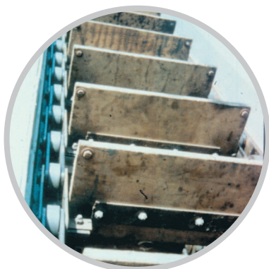
Конвейерные цепи со скребковыми аттачментами для перемещения рыбной продукции в Перу.
