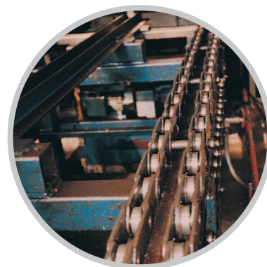
Специальная двуветвевая конвейерная цепь, которая используется на заводе по изготовлению гофрированных кровельных материалов в Чили.
