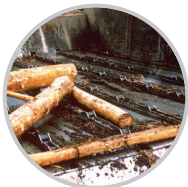
Специальная цепь Renold, сконструированная для транспортера бревен, который используется на целлюлозно-бумажном комбинате обрабатывающем 1200 тонн древесины в день.
