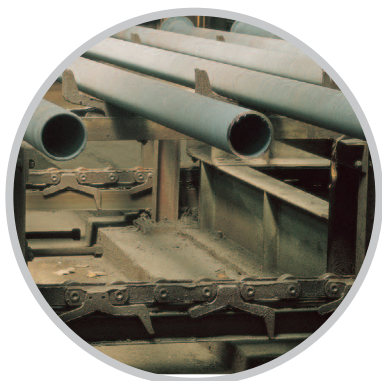
Две ветви специальной конвейерной цепи несут бесшовные чугунные трубы.
