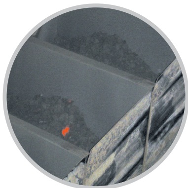
Специальные двуветвевые конвейерные цепи разработаны для продления срока эксплуатации цепи в горячих и пыльных условиях при работе с цементным клинкером.
