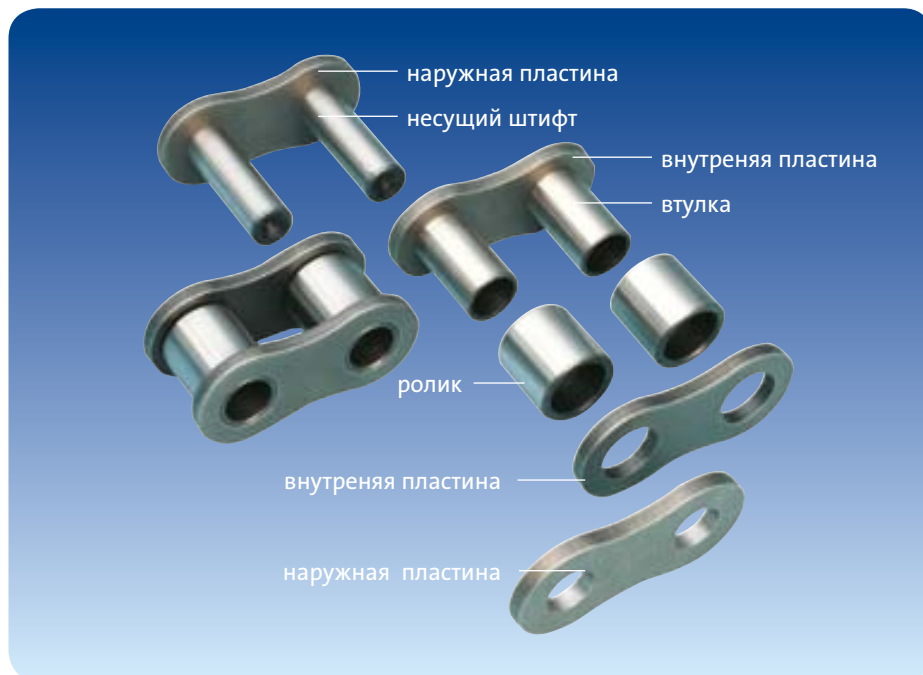
№ 11 Соединительное звено – свободная посадка (BS/DIN/ANSI)
