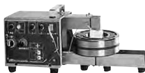
Индукционный нагреватель для подшипников (кат. E398)
