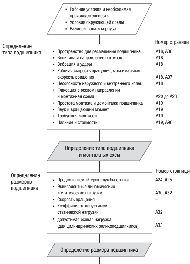
Рисунок 2.1. Схема подбора подшипников качения
