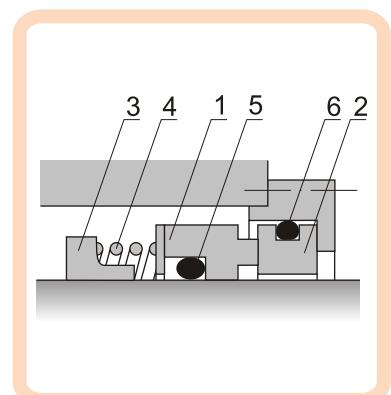
Торцовое уплотнение обладает свойством самоприрабатываемости; при правильном подборе материала поверхностей трения и подводе незначительного количества смазки уплотнение может работать в течение долгого времени при хорошем состоянии поверхностей контакта, обеспечивающем надёжное уплотнение.
