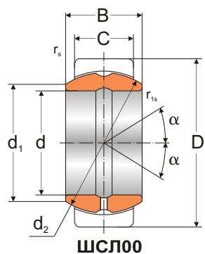
**Подшипники шарнирные с двумя разломами наружного кольца
