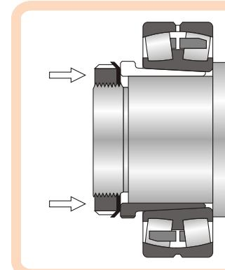
Поскольку коническое соединение подшипника и втулки является само стопорящимся, монтажная гайка по окончании затяжки может быть удалена и заменена стопорной гайкой. Такой способ может быть использован также при установке подшипников с закрепительной втулкой или непосредственно на коническую шейку вала.
