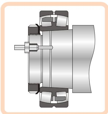
Наиболее эффективным является использование гидравлической гайки. Гидравлическая гайка навинчивается на вал. Поршень гайки устанавливается с упором во внутреннее кольцо подшипника. Последующая подача масла в гайку и на сопряженные поверхности вала и подшипника разжимает поршень, обеспечивая смещение подшипника в соответствующее положение.
