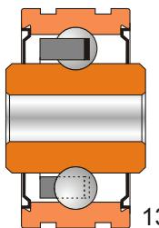
Подшипники шариковые радиальные однорядные с двумя защитными шайбами, специальные (13)
