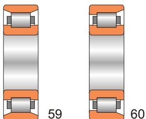
Подшипники роликовые радиальные с короткими цилиндрическими роликами однорядные без бортов на наружном кольце (59) или с однобортовым наружным кольцом (60)
