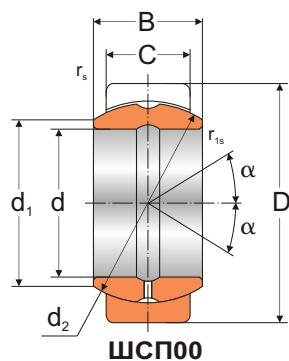
**Подшипники шарнирные с одним разломом наружного кольца
