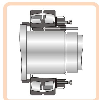
Гидравлический демонтаж подшипника со стяжной втулкой также облегчает завинчивание шлицевой гайки с помощью накидного ударного ключа. Резьбу стяжной втулки и торец подшипника следует смазать.
