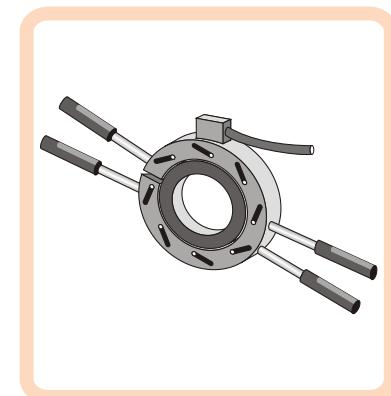
практически безопасны в эксплуатации, просты в обслуживании и обращении. Сопла газовой горелки должны находиться на расстоянии 40-50 мм от поверхности кольца. Обычно диаметр сопла составляет 2 мм. Сопла располагаются в шахматном порядке на расстоянии 20-40 мм друг от друга. Температура и длина пламени регулируется подачей воздуха. Горелка должна удерживаться концентрически кольцу и медленно и плавно перемещаться в осевом направлении.
