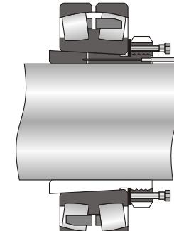
При использовании шлицевой гайки усилие затяжки гайки воздействует на осевое смещение подшипника. Подача масла под давлением на сопряженные поверхности вала и подшипника облегчает завинчивание гайки в процессе монтажа.
