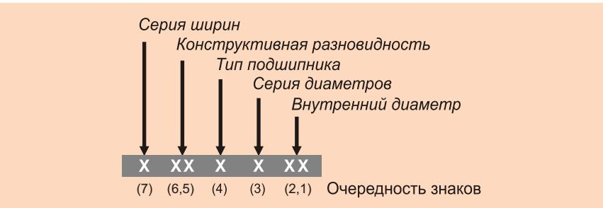
Дополнительные знаки условного обозначения располагают справа (суффикс) и слева (префикс) от основного условного обозначения.
