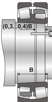
Подшипник можно устанавливать непосредственно на коническую шейку вала методом подачи масла под давлением между сопряженными поверхностями, при котором усилия от затяжки болтов воздействуют на перемещение подшипника через промежуточную деталь.
