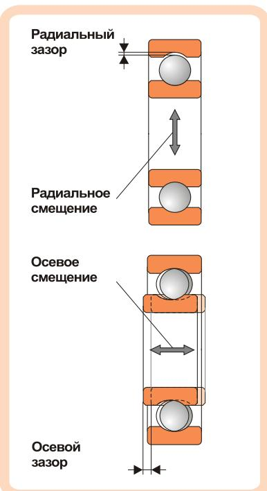
Под посадочным радиальным зазором понимают зазор, установленный после монтажа подшипников. Причинами его изменения является упругая деформация колец, вызванная посадочными натягами и погрешностями формы посадочных мест.
