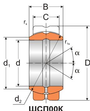
**Подшипники шарнирные с одним разломом наружного кольца
