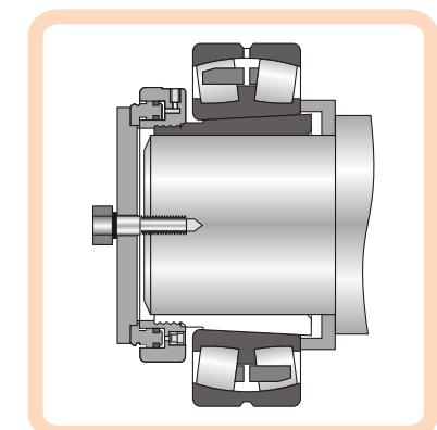
Демонтаж подшипников со стяжной втулкой можно производить с помощью шлицевой гайки, навинчивающейся на накидным ключом на резьбу втулки.
