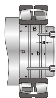
Демонтаж подшипников со стяжной втулкой упрощает применение гидравлической гайки с одновременным подводом масла на сопряженные поверхности подшипника и втулки.
