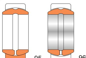
Подшипники шарнирные с одним (95) или двумя разломами наружного кольца, с отверстиями и канавками для смазки во внутреннем кольце (96)
