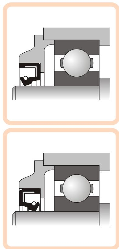
ли наибольшее распространение манжеты на основе бутадиен-нитрильного каучука; силиконового каучука; фторкаучука; фторопласта.
