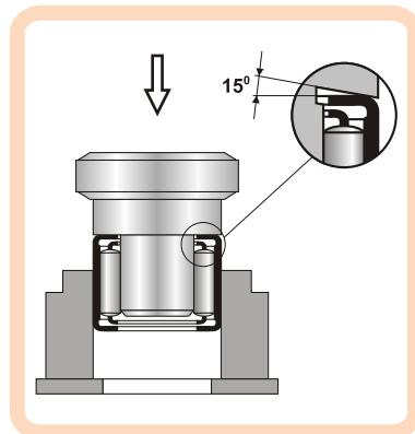
Бесколечные игольчатые подшипники устанавливаются между валом и корпусом. Для того чтобы избежать задиров на дорожках качения и роликах, бесколечный игольчатый подшипник при монтаже необходимо слегка поворачивать и оставлять ненагруженным.
