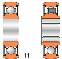
Подшипники шариковые радиальные однорядные с двусторонним уплотнением и сферической поверхностью наружного кольца (11)
