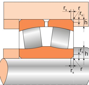
Высота заплечика сопряженной детали должна быть такой, что поверхность прилегания монтажной фаски была бы достаточной даже при наибольшей величине координаты монтажной фаски. В таблице указаны наибольший размер радиуса  $r$  и наибольший размер высоты заплечиков  $h$ .
