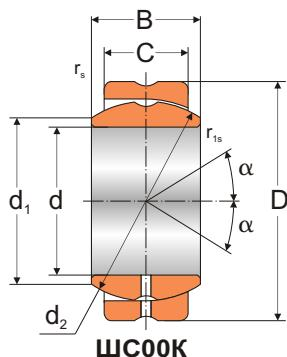
**Подшипники шарнирные с отверстиями и канавками для смазки
