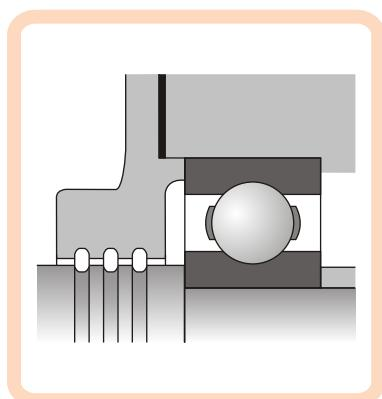
вения внутрь корпуса влаги извне могут быть применены двусторонние резьбовые канавки, направленные в противоположные стороны.
