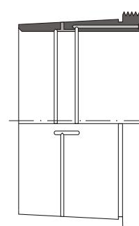
Подшипник можно также устанавливать непосредственно на коническую шейку вала или на стяжной втулке методом подачи масла под давлением между сопряженными поверхностями при одновременном использовании шлицевой или гидравлической гайки, которая воздействует на установку подшипника.
