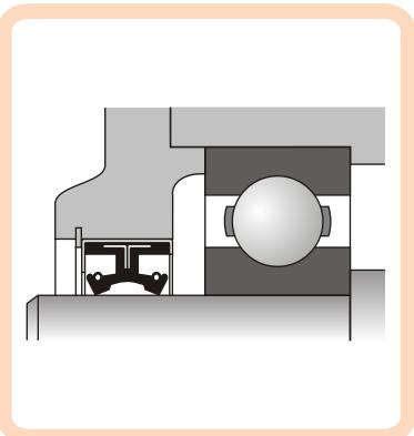
Чтобы манжета не выпрессовывалась из корпуса от воздействия различных вибрационных нагрузок, её фиксируют в осевом направлении.
