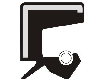
Для тяжёлых условий работы применяются манжеты с более высокой радиальной жёсткостью за счёт дополнительного опорного кольца.
