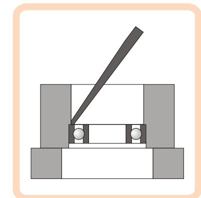
Если вместо молотка используется пресс, то опорой служит стопорная гайка закрепительной втулки.
