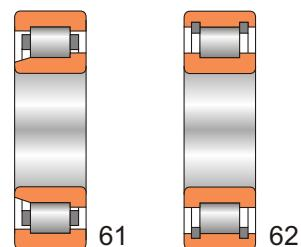
Подшипники роликовые радиальные с короткими цилиндрическими роликами однорядные с однобортовым внутренним кольцом (61) или с безбортовым наружным кольцом и двумя запорными шайбами (62)
