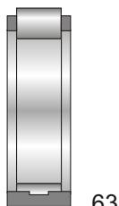
Подшипники роликовые радиальные с короткими цилиндрическими роликами однорядные без колец (63)
