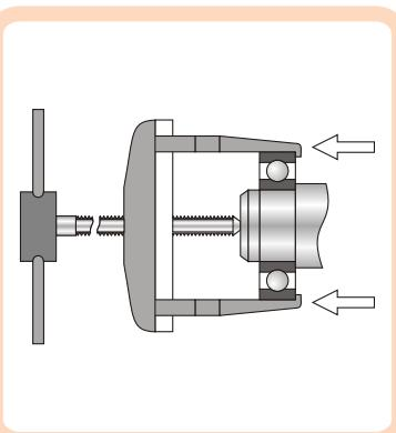
В случае с неразъемными подшипниками первоначально демонтируется посадка с зазором.
