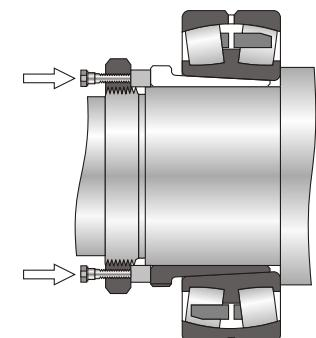
Чтобы избежать перекоса подшипника и втулки монтажная гайка должна периодически затягиваться, чтобы служить опорой для торцевой поверхности втулки. Нажимные болты из закаленной стали равномерно располагаются по монтажной гайке и затягиваются по диагонали. Количество болтов зависит от требуемых усилий затяжки.
