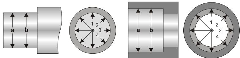
Кроме случаев особо оговоренных в сборочном чертеже, допуск на цилиндричность не должен превышать половины допуска на диаметр. Полный контакт внутреннего кольца подшипника на конической шейке вала требует точного соответствия посадочных поверхностей подшипника и вала.
