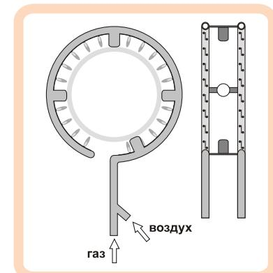
Иногда сильная контактная коррозия или холодная сварка могут сделать невыполнимым демонтаж кольца без его разрушения. В таких случаях кольцо разогревается сварочной горелкой до 350°C и поливается водой. Во избежание несчастных случаев от внезапного разрыва кольца необходимо соблюдать меры предосторожности и предусмотреть ограждение участка, на котором происходит
