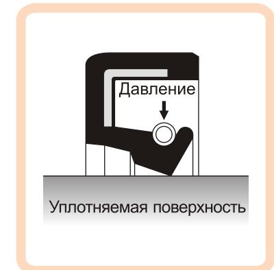
Манжеты являются самостоительной конструкцией, пригодной для непосредственной установки в корпус. Если основным назначением уплотнения является защита подшипника от попадания частиц грязи извне, то уплотнение устанавливается в корпус кромкой наружу.
