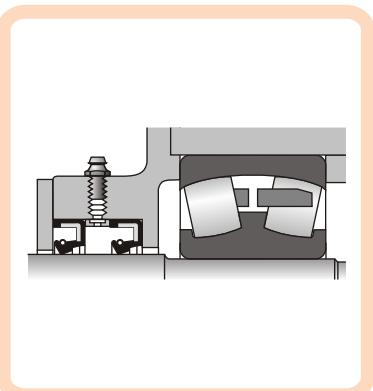
Для одновременной защиты от попадания частиц грязи извне и удержания смазочного материала, либо в случае разделения двух сред, устанавливают направленные в разные стороны уплотнения или, в целях экономии пространства, - сдвоенные манжеты с противоположно направленными кромками.
