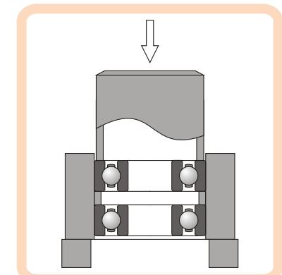
Для разборки подшипниково-узла можно использовать приспособление, которое крепится к корпусу через отверстия, предназначенные для крепления крышки. Усилие демонтажа передается через специальную гайку на наружное кольцо подшипника, выпрессовывая его вместе с валом из корпуса.
