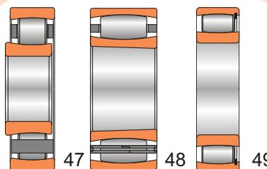
Подшипники роликовые радиальные торOIDальные однорядные с пластмассовым (47), латунным сепаратором (48) и без сепаратора (49)
