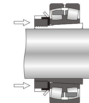
Гайка на валу также используется для запрессовки стяжных втулок малых размеров между валом и внутренним кольцом подшипника.
