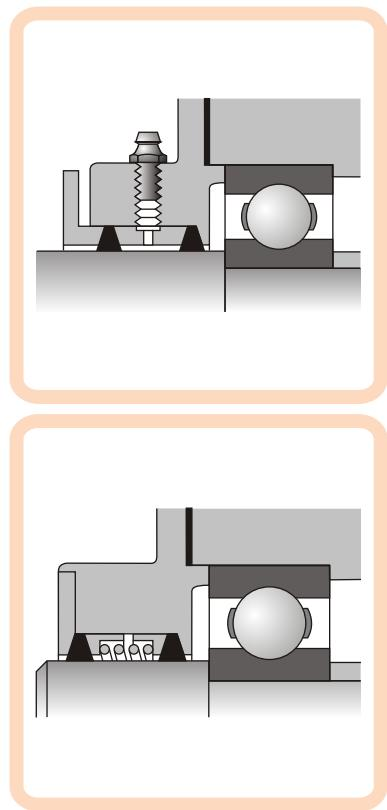
Достоинства V-образных колец заключаются в особой простоте монтажа и замены. Кольца можно растягивать, передвигать по валу через соседние детали (фланцы, шкивы); в отдельных случаях во избежание демонтажа большого количества деталей бывает целесообразно новое кольце разрезать и после установки на валу сварить стык с помощью переносного
