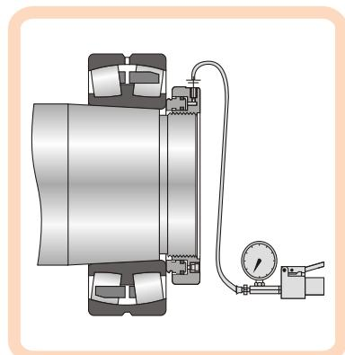
Монтаж подшипников с закрепительной втулкой можно производить перемещением поршня гидравлической гайки навинченной на втулку.
