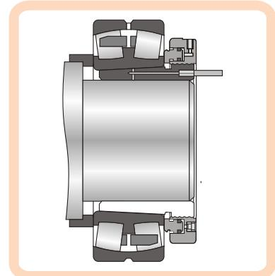
Демонтаж подшипников с коническим отверстием производится подачей масла под давлением на сопряженные поверхности. Сопряженные поверхности разъединяются с резким отрывом. Величину смещения подшипника, стяжной втулки при разъединении сопряженных поверхностей следует ограничивать.
