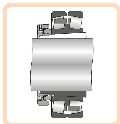
Монтаж подшипников со стяжной втулкой можно производить запрессовкой втулки поршнем гидравлической гайки навинченной на вал.
