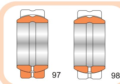
Подшипники шарнирные с одним (97) или двумя разломами наружного кольца, с отверстиями и канавками для смазки во внутреннем и наружном кольцах (98)
