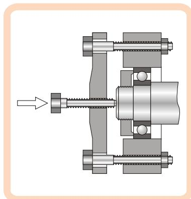
Демонтаж подшипников в значительной степени облегчается, если на валу предусмотрены выемки для захватов съемника.
