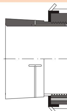
При запрессовке стяжной втулки и установке подшипника с закрепительной втулкой усилия от затяжки болтов должны передаваться через промежуточную шайбу.
