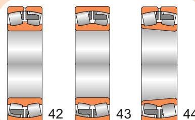
Подшипники роликовые радиальные сферические двухрядные в виброустойчивом исполнении с цилиндрическим (42, 43) и коническим отверстием (44)
