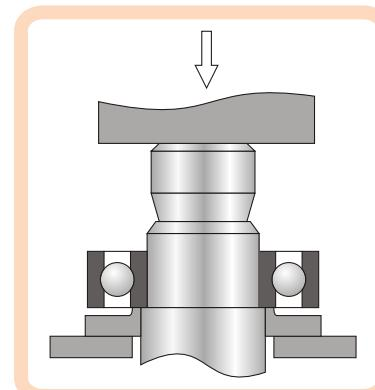
вала или в корпус, лучше всего производить, используя ручной или гидравлический пресс. При этом усилие демонтажа передается тому кольцу подшипника, которое установлено с натягом.
