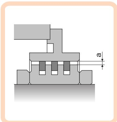
Кольца устанавливают с небольшим натягом по отношению ко втулке, для обеспечения монтажа на последней выполняют пологую монтажную фаску с диаметром D превышающим начальный диаметр до пружинных колец.
