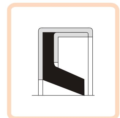
Манжетные уплотнения без пружин применяются, главным образом, для защиты от пыли и удержания пластичной смазки в опорах при умеренных частотах вращения валов.
