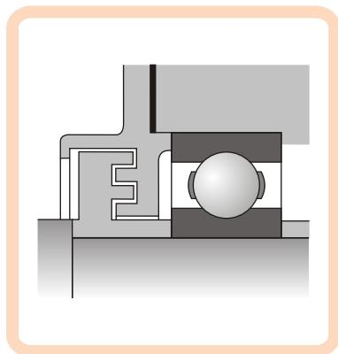
В абсолютном большинстве случаев для повышения эффективности лабиринтных уплотнений зазоры в них заполняются пластичной смазкой, независимо от того, работает подшипник на пластичной либо жидкой смазке. В конструкции уплотнения обычно предусматривается полость и каналы для поступления смазки в зазоры путем закачивания ее под давлением.
