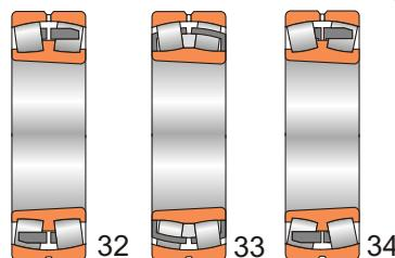
Подшипники роликовые радиальные сферические двухрядные с коническим отверстием (32, 33, 34)
