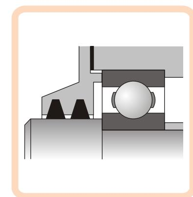
Надёжность сальника резко возрастает при подводе смазочного материала, так как при этом уменьшается коэффициент трения, тепловыделение и повышается герметичность.
