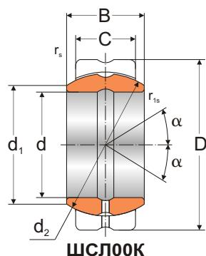
**Подшипники шарнирные с двумя разломами наружного кольца
