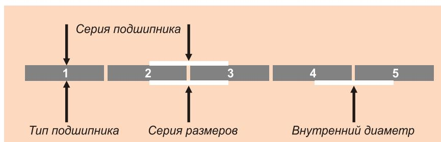
Первая цифра или буква (либо комбинация букв) в базовом обозначении указывают на тип подшипника.
