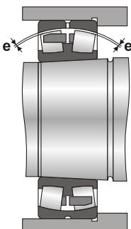
Гайка на закрепительной втулке и накидной гаечный ключ могут применяться для монтажа подшипника с закрепительной втулкой.
