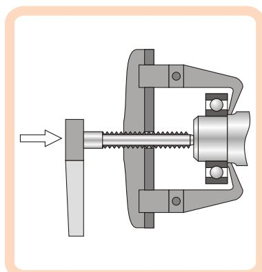
Если захваты съемника не достают до борта внутреннего кольца подшипника, возможно приложение усилия демонтажа через смежную деталь.
