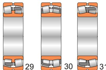
Подшипники роликовые радиальные сферические двухрядные с цилиндрическим отверстием (29, 30, 31)
