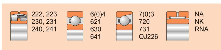
Последние две цифры базового обозначения указывают код размера подшипника, полученный от деления номинального диаметра отверстия в миллиметрах на 5. Исключения составляют:
