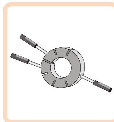
каналы, отсутствуют возможности применения индукционных нагревательных устройств, то внутренние кольца больших разъемных подшипников можно демонтировать с помощью кольцевой газовой горелки.
