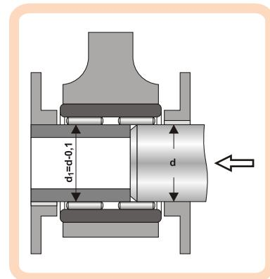
допуска H11 предохраняет подшипник от заклинивания.
