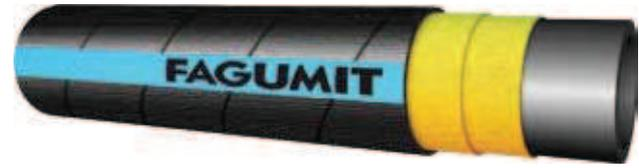
• wielofunkcyjny, elastyczny wąż przeznaczony do przepływu wody przemysłowej o temp. do +100°C i niektórych lekkich chemikaliów • wew. warstwa gumowa: EPDM/SBR, czarna, gładka • wzmocnienie: tekstylne • zew. warstwa gumowa: EPDM/SBR, czarna, gładka lub z odciskiem tkaniny, odporna na czynniki atmosferyczne • węże mogą być wykonane w wersji kolorowej
