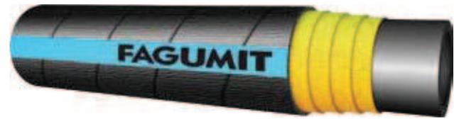
• wielofunkcyjny, elastyczny wąż przeznaczony do przepływu wody oraz lekkich chemikaliów • temp. pracy: od -25°C do +70°C • wew. warstwa gumowa: EPDM/SBR, czarna, gładka • wzmocnienie: tekstylne • zew. warstwa gumowa: EPDM/SBR, czarna, gładka lub z odciskiem tkaniny, odporna na czynniki atmosferyczne
