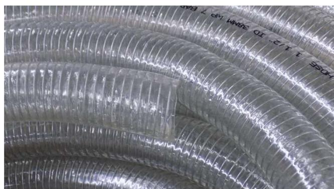
**ПРИМЕНЕНИЕ:** Напорно-всасывающий рукав для транспортировки пищевых жидкостей, напитков, фруктовых соков, уксуса, вина и спиртных напитков с концентрацией алкоголя до 20% при температуре до 25°C, уксусной кислоты, муки, круп, сахара, молока, растительного масла, воздуха под давлением. Широко применяется в сельском хозяйстве и системах ирригации. Может быть использован в очистных сооружениях.
