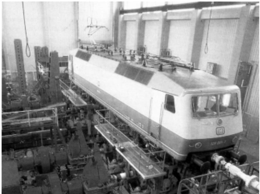
CONTI® Luftfedern für die Lagerung eines Prüfstand-Fundamentes
