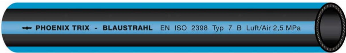
**Маркировка:** 6 голубые полосы на черном фоне "PHOENIX TRIX-BLAUSTR AHL EN ISO 2398 Typ 7 B Luft/Air 2,5 MPa (25 bar) DN 19 x 6 R <math>10^6 \Omega/m</math> Made in Germany"
