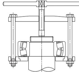
Рис. 8.53 Демонтаж подшипника с помощью специального съемника
