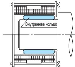
Рис. 8.55 Снятие внутреннего кольца с помощью индукционного нагревателя
