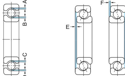
Рис 6.1 Радиальный внутренний зазор = A + B + C + D
