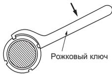
Рис. 8.51 Демонтаж подшипника с помощью рожкового ключа
