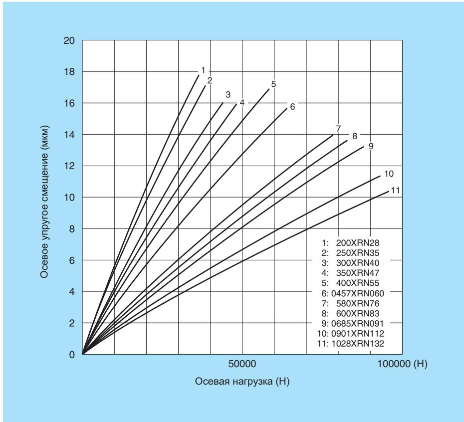
**Конические роликовые подшипники с перекрещивающимися роликами**
