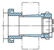
Рис. 8.18 Монтаж на коническом валу с использованием пружинного кольца, гайки и шайбы
