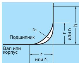
Рис. 8.7 Размер фаски, радиус галтели и высота заплечика
